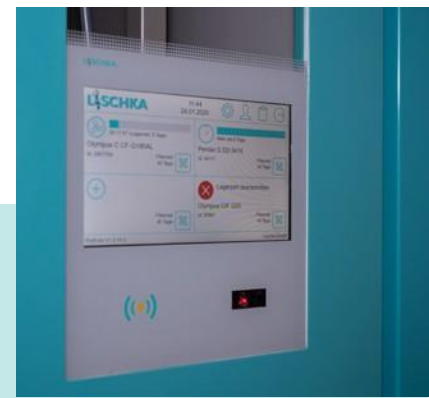
Einzel-trocknung der Endoskopkanäle durch HEPA gefilterte Luft
